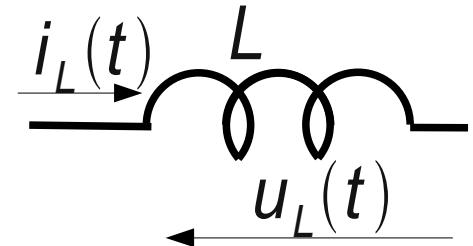
$$u_L(t) = L \cdot I_L \sqrt{2} (-\omega \cdot \sin(\omega \cdot t)) = U_L \sqrt{2} \cos(\omega \cdot t + \varphi)$$
