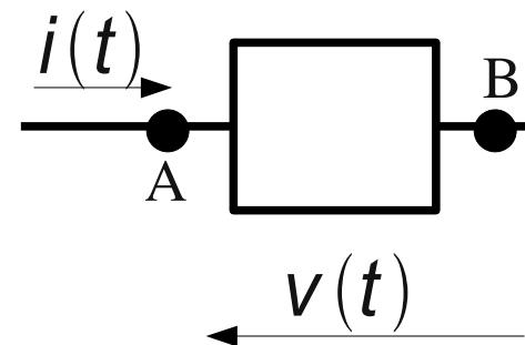
Pour : -  $i(t) > 0$ , le sens réel du courant correspond à celui de la flèche,
