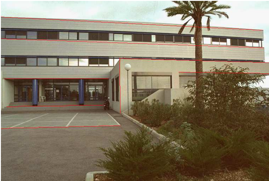
FIG. 4.2 – Image originale : des droites ont été superposées afin de mettre en évidence les distorsions
