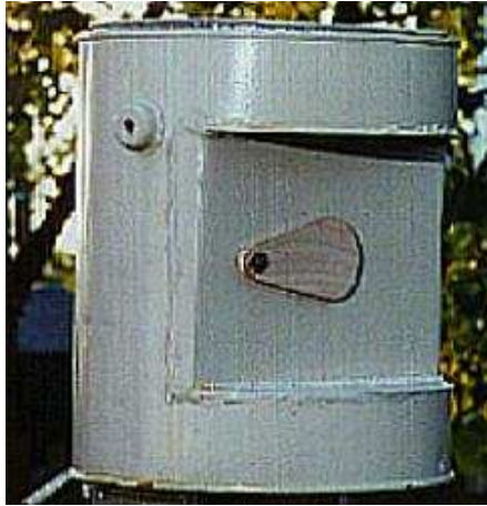
FIG. 1.2 – Un exemple de caméra sténopée fabriquée à partir d'une boîte de conserve.
